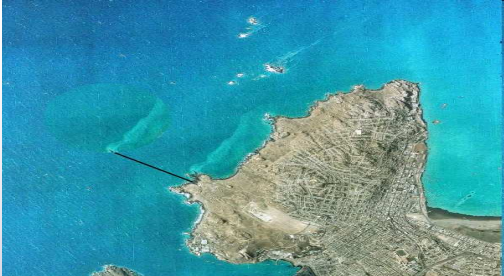
Fotografía aérea de la península de Coquimbo (Fuente: SINIA) con la posición y pluma de aguas servidas del emisario antiguo (cerca de la costa) y la proyección del emisario actual
